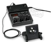
PASCO LED-Stroboskop m. Steuergerät
