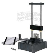
PASCO Gerät zur Messung der Zugfestigkeit von
