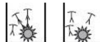
Die Vertiefungen werden mit einem Konjugat behandelt, welches einen zweiten Antikörper enthält, er an menschliche HIV-Antikörper bindet.
