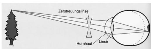
Abb. 8: Das kurzsichtige Auge mit Brille – scharfes Bild auf der Netzhaut
