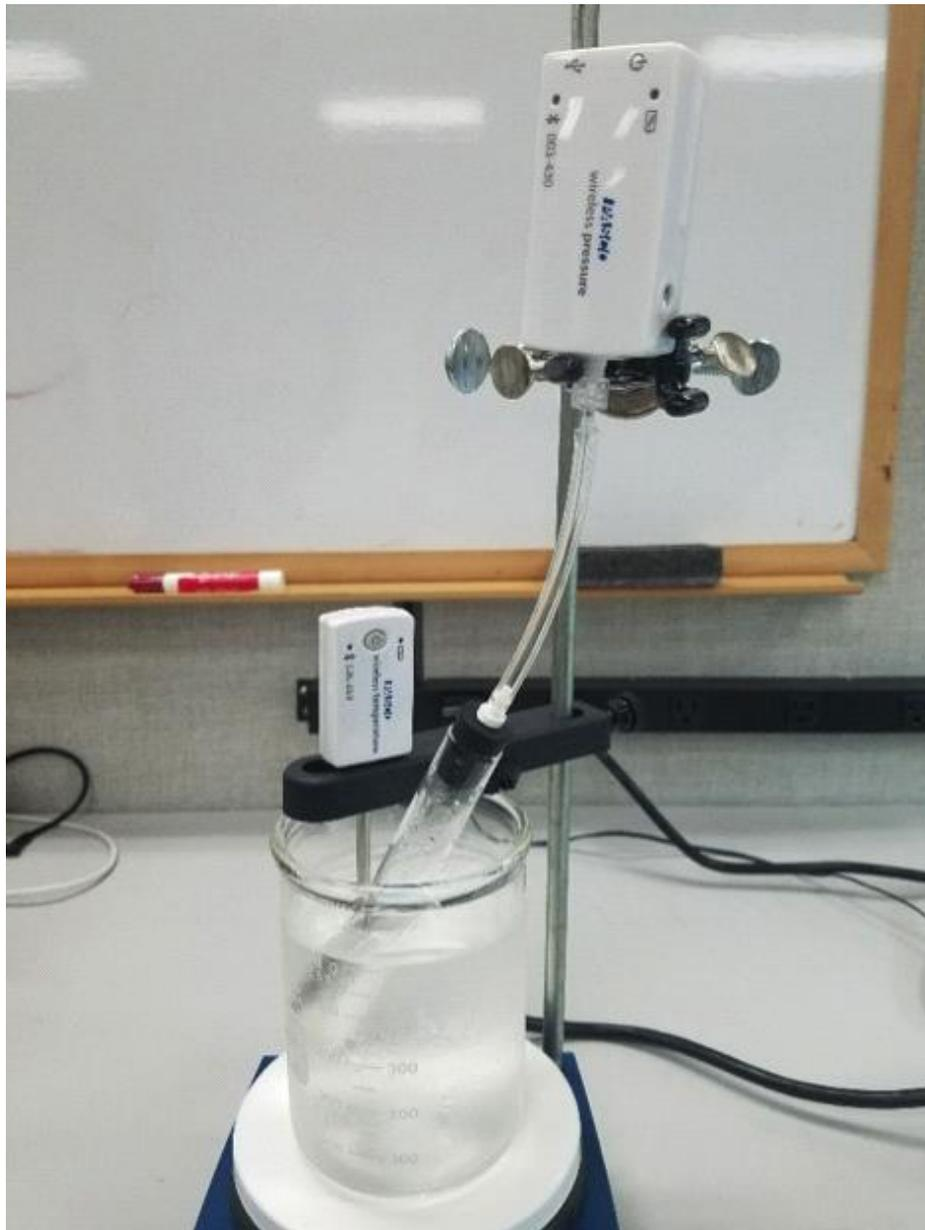
Abb. 1: Versuchsaufbau zur Messung der Enzymaktivität von Katalase.
