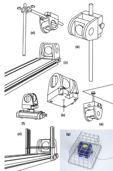
Um den drahtlosen Bewegungssensor vor dem Aufprall eines Objekts zu schützen, verwenden Sie eine Vorrichtung wie den Bewegungssensorschutz (g) oder Fotogate-Halterungen mit einem Gummiband (h). Der Sensor kann durch ein Drahtgitter oder ein Gummiband, das in der Nähe des Wandlers angebracht ist, "durchschauen".
