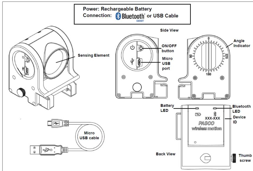
Der Sensor misst Entfernungen zu einem Objekt von 15 Zentimetern bis 4 Metern. Das Sensorelement kann um 180 Grad gedreht werden. Der Sensor kann am Ende jeder PASCO-Spur oder an einer Stativstange montiert werden.
