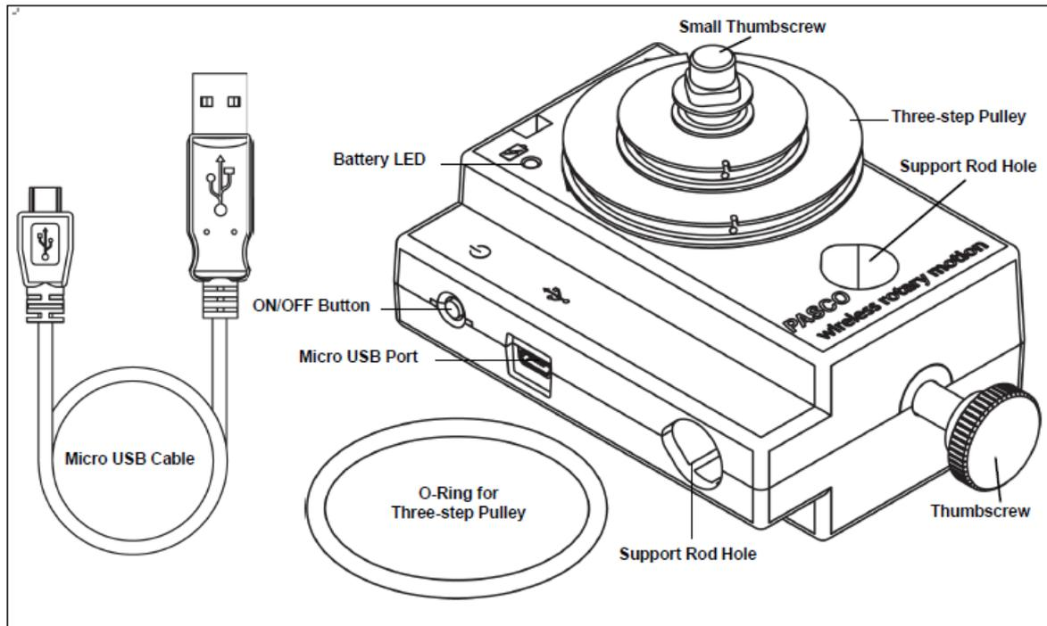
Der Smart Drehbewegungssensor misst Winkel mit einer Auflösung von  $0,18^\circ$  und erkennt die Drehrichtung.
