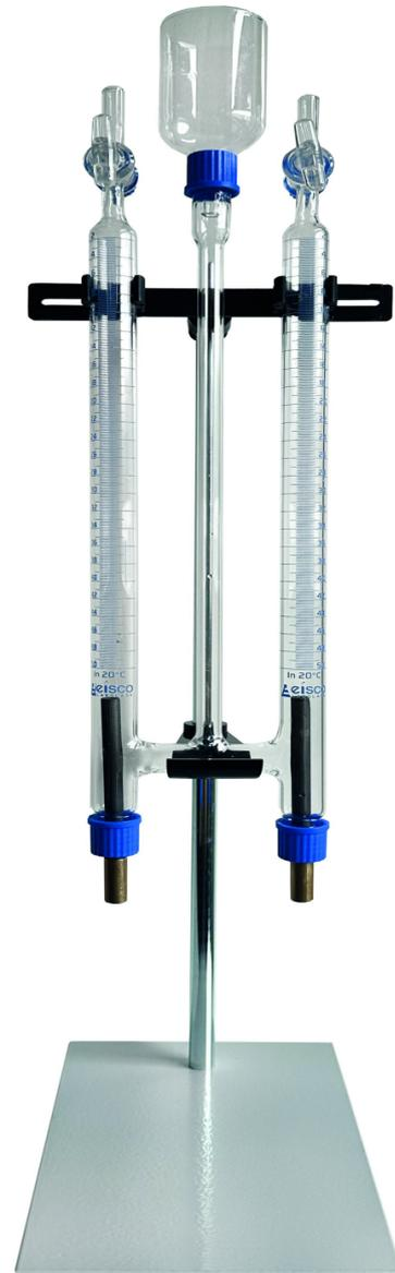
Dabei wird das Wasser in seine beiden Bestandteile Sauerstoff und Wasserstoff zerlegt. Die entstehenden Gase sammeln sich in den beiden Messrohren und können mit Hilfe eines Hahns entnommen werden. An der Kathode werden die Oxoniumionen, welche durch Protolyse der zugesetzten Säure entstanden sind, zu Wasserstoff reduziert und an der Anode das Wasser zu Sauerstoff und zu Oxoniumionen oxidiert.
